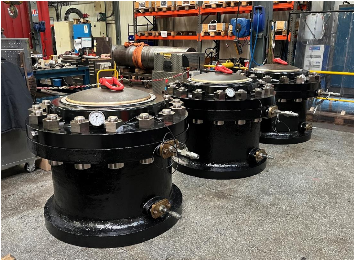
Les 3 presses de basculement ©F. Thomas - Ports de Normandie
