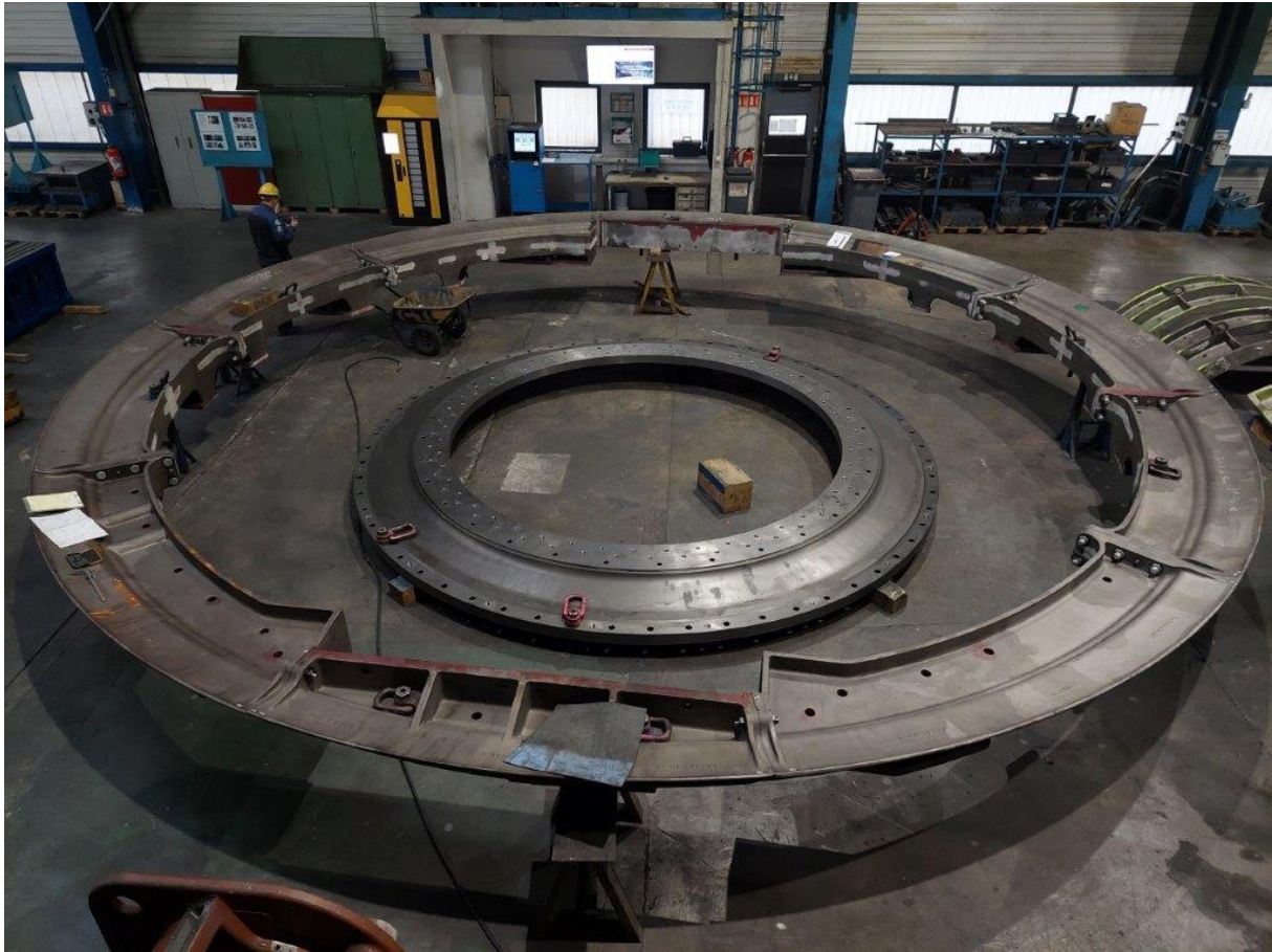
La couronne de rotation du pont ©Eiffage Métal
