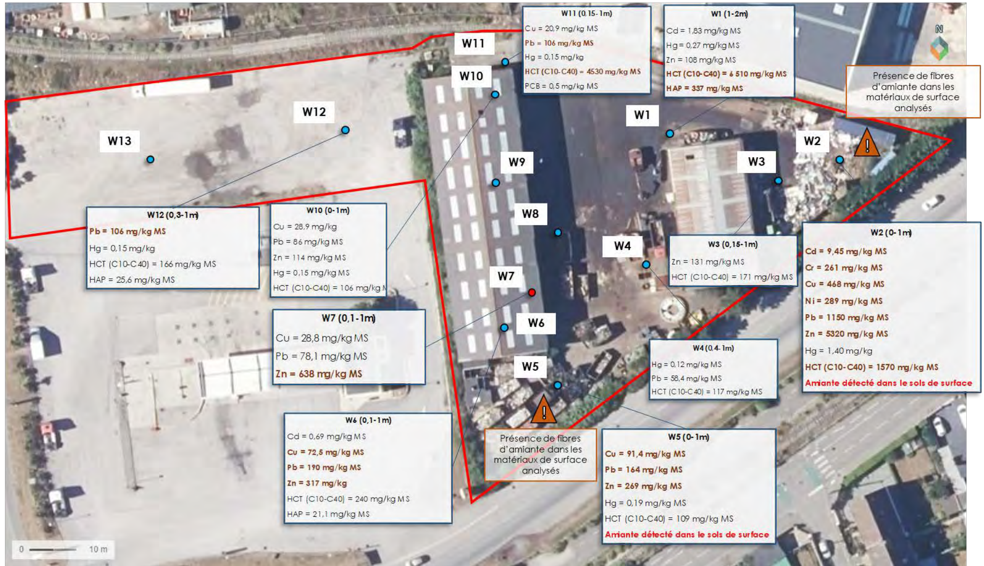
Figure 15 : Cartographie des anomalies et impacts dans le milieu sol
