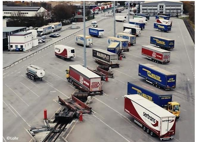
Les wagons LOHR permettent le chargement et le transport de semi-remorques standards de 4m de hauteur dans le gabarit UIC GB1 ou AFM423 faisant l'objet d'une normalisation européenne et de tous les types de semi-remorques conformes aux Directives Européennes.
